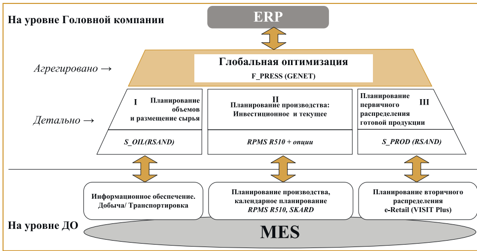
Рис. 2. Комплекс интегрированного планирования, встроенный в существующую структуру ВИНК. Указаны задачи двух уровней управления ВИНК, названия используемых систем и номера «задач» — I, II, III
