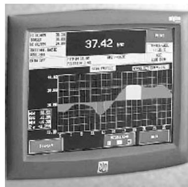
Рис.5. Графическое отображение измерения толщин системы управления SUPERCOM 9000 фирмы MACRO Engineering and Technology Inc
