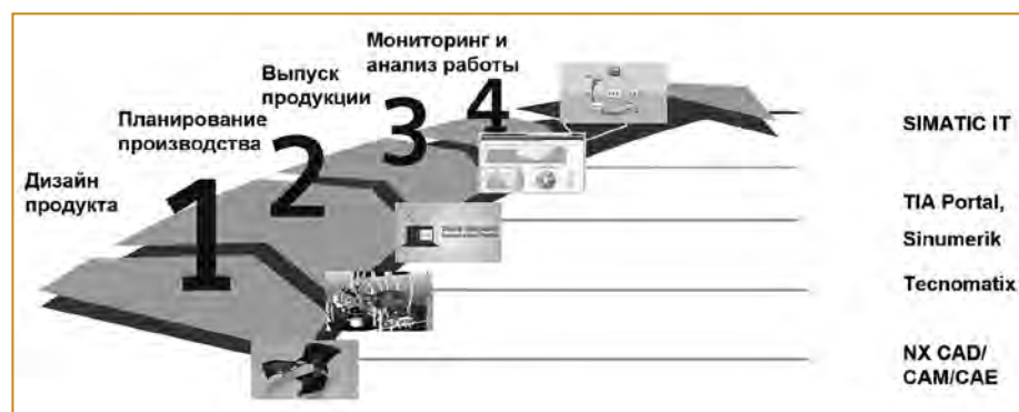
Рис. 2. Жизненный цикл продукта в соответствии с концепцией «Индустрии 3.0», сквозное решение компании Siemens AG
