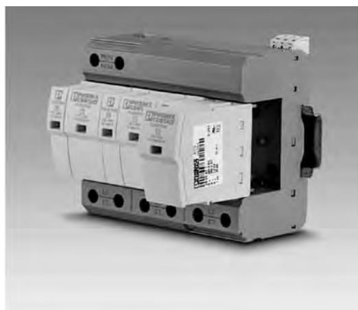
Рис. 2. УЗИП FLT-SEC-T1+T2 — две независимые ступени защиты в одном корпусе: класс 1 — на базе разрядников нового поколения, класс 2 — на базе варисторов
