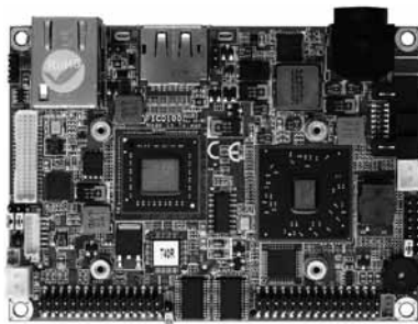
Рис. 7. Одноплатный компьютер предельно компактного исполнения PICO100 на базе новейших процессоров серии AMD G-Series не требующих охлаждения
