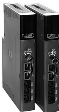
Рис. 3. Внешний вид модуля CPU715
