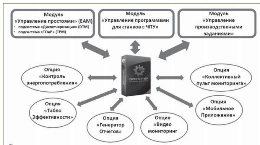
Рис. 1. Модули АИС "Диспетчер"
