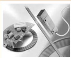
Семейство успешно зарекомендовавших себя магнитных датчиков линейных перемещений MLFK пополнилось новой серией устройств, при помощи которых можно достичь точности измерения около 20 микрон. Принцип работы датчика – бесконтактный. Основой измерительной системы является металлическая лента, на одну сторону которой нанесен композиционный материал на основе упругого полимера, содержащего феррит.
