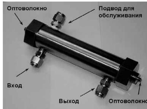
Рис. 2. Поточный измерительный модуль
