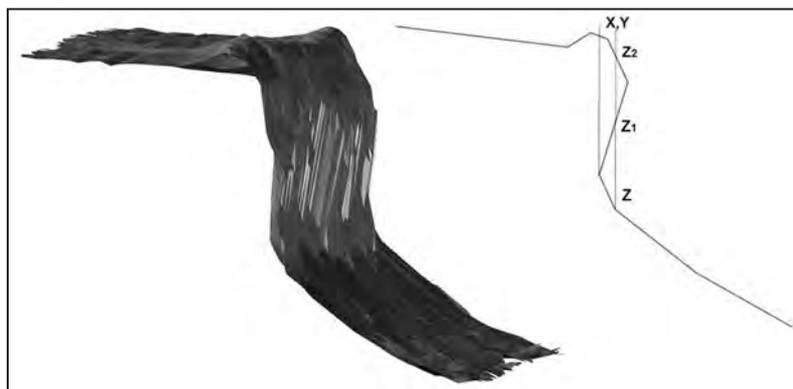
Рис. 2. Сечение уступа угольного разреза с уклоном  $>90^\circ$ , 3D-вид, сечение
