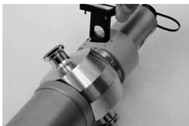
Рис. 3. Использование эталонного цветового фильтра для калибровки датчика
