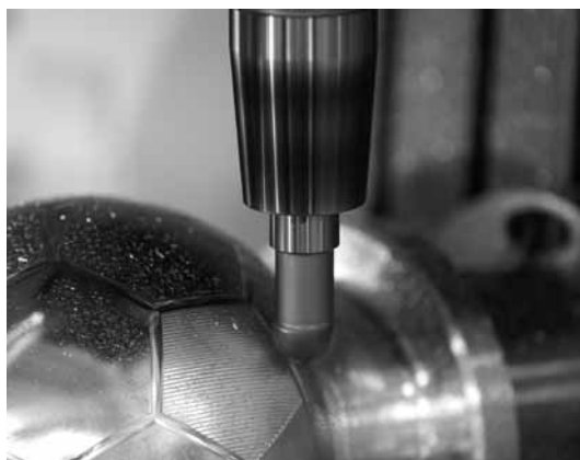
Рис. 3. 5-осевая обработка детали футбольный мяч Telstar
