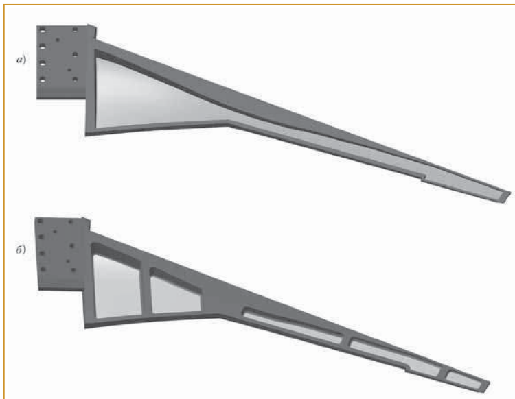
Рис. 6. Ниша центральной части консоли крыла магистрального самолета: под размещение сервоприводов системы управления механизацией крыла (а) с усиливающими перегородками (б)
