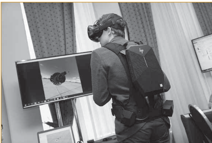
Рис. 2. Минимальный комплект оборудования: ПК с мощной графической станцией, шлем и ПО
