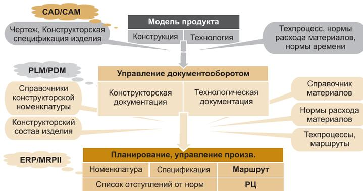
Рис. 1. Общая схема интеграции CAD/CAM, PDM и ERP-систем
