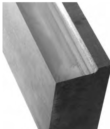
Рис. 4. Деталь, обработанная с АСС: при такой же подаче и глубине резания поверхность не имеет следов ряби
