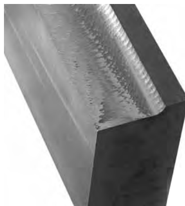
Рис. 3. Деталь, обработанная без АСС: видны отчетливые следы ряби
