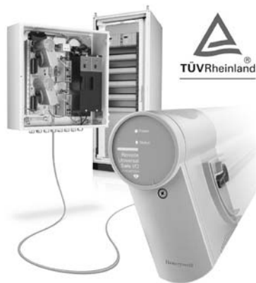
Рис. 5. Контроллер Safety Manager с удаленными модулями ввода/вывода
