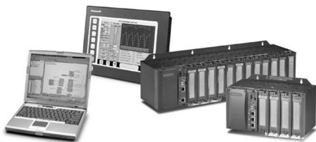
Рис. 4. Контроллер HC900 и операторская панель
