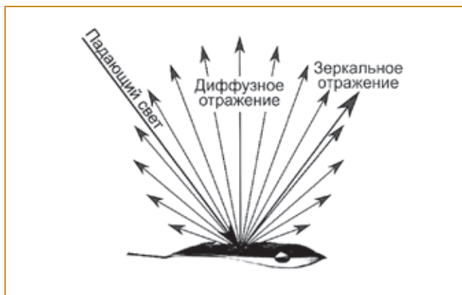
Рис. 1. Формирование зеркальной и диффузной составляющих отраженного излучения
