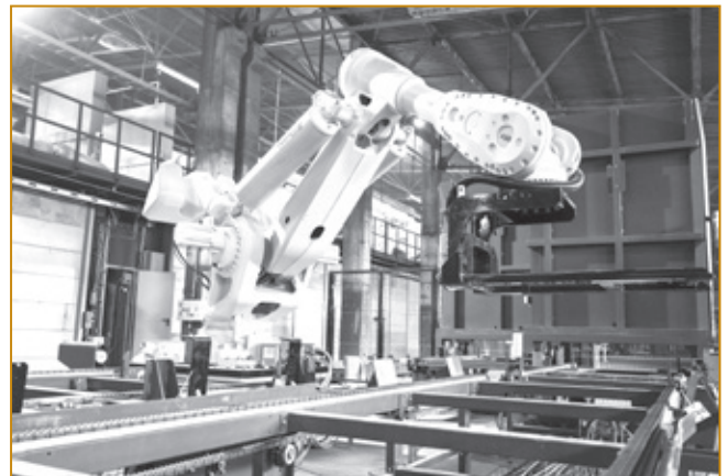
Рис. 1. Самый крупный робот ABB IRB 8700 на производстве Магнезит
