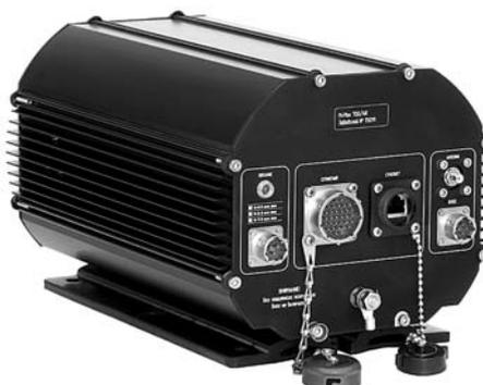
Рис. 3. Защищенный компьютер M-Max 700 — регистратор сигналов АБТ и АЛС
