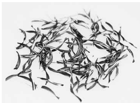
Рис. 6. Сегментная стружка, полученная с использованием технологии Vortex
