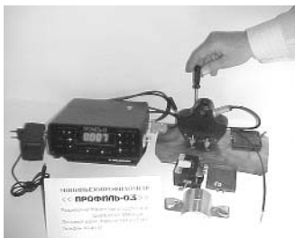
Рис. 2. Общий вид микропрофилометра для контроля шероховатости [3]. Затем из массива данных исключаются составляющие, периоды которых больше базового периода, т. е. относятся не к шероховатости, а к волнистости, и, если такие составляющие есть (в ряде случаев они могут отсутствовать), уточняется значение параметра R_a .
