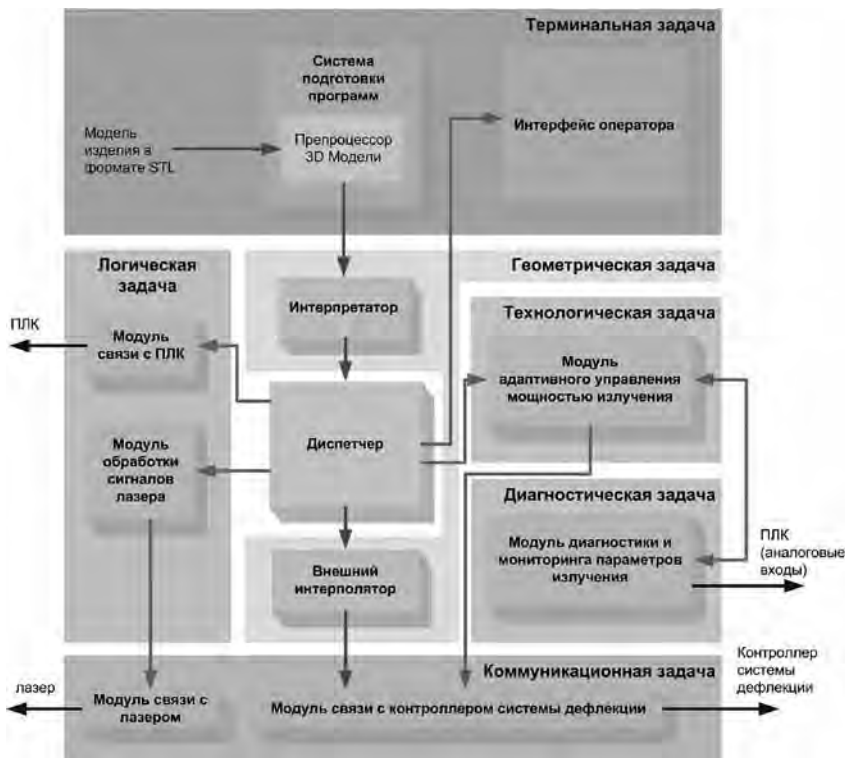
Рис. 2. Модульная структура системы управления установкой лазерного синтеза
