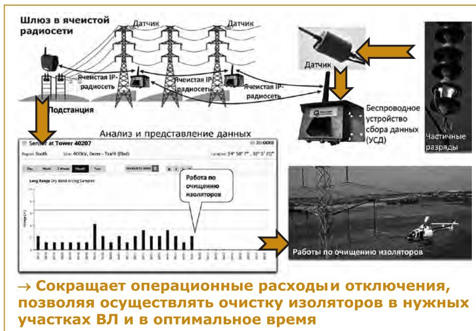
Рис. 1. Принципиальная схема системы мониторинга изоляторов
