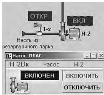
Рис. 3. Управление насосом
