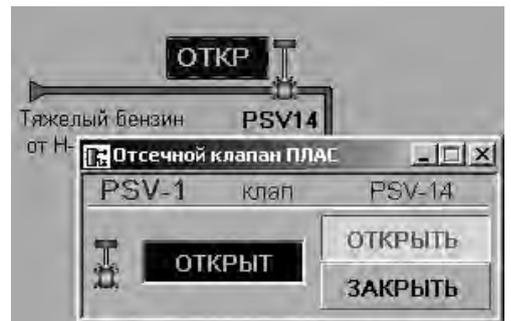
Рис. 4. Управление отсечным клапаном
