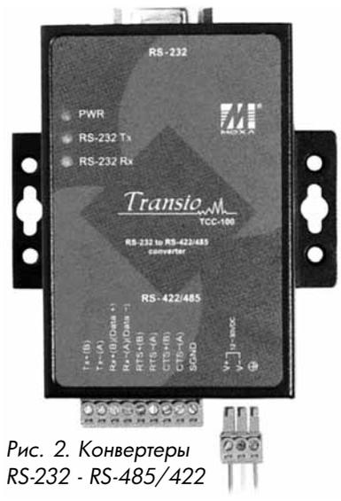
Рис. 2. Конвертеры RS-232 - RS-485/422
