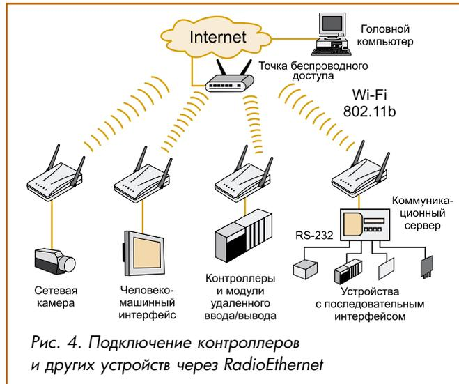
Рис. 4. Подключение контроллеров и других устройств через RadioEthernet
