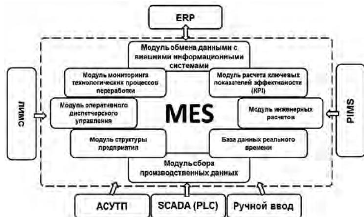
Рис. 1. Модульная структура решения, внедряемого ОАО АНК «Башнефть»
