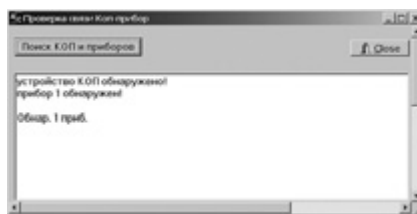
Рис. 4. Основное назначение программы TstKop — определение наличия платы КОП и подключенных к ней приборов
