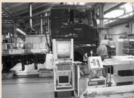
Стандартизованная комбинация панели Ethernet с модулями терминала ввода/вывода шины Ethernet позволяет эффективно и с минимальными экономическими затратами выполнять требования MDA/PDA для механических станков в группе MAN. В то же время динамическая пересылка/загрузка управляющих программ для станков может осуществляться из единого центра. Панели Ethernet используются в качестве интерфейса оператора. Технологии Beckhoff используются в компании для сбора производственных данных (СПД).
