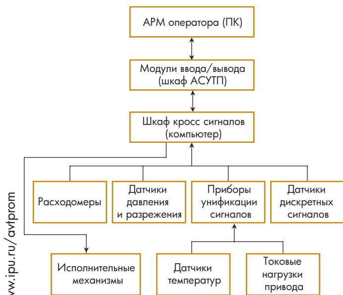
Рис. 2. Структурная схема АСУТП Обжиг
