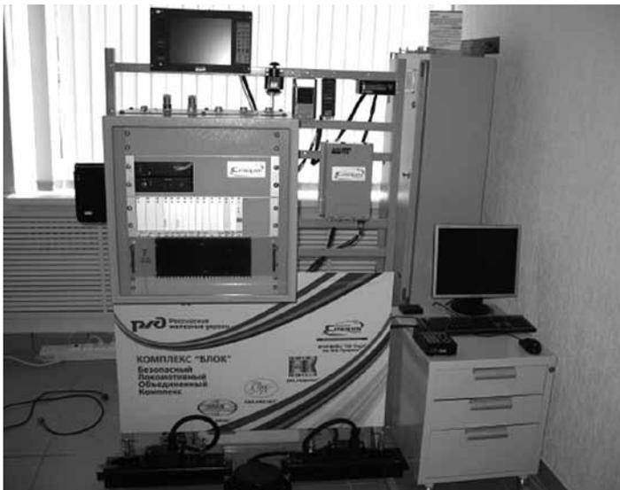
Рис. 5. Безопасный локомотивный объединенный комплекс БЛОК
