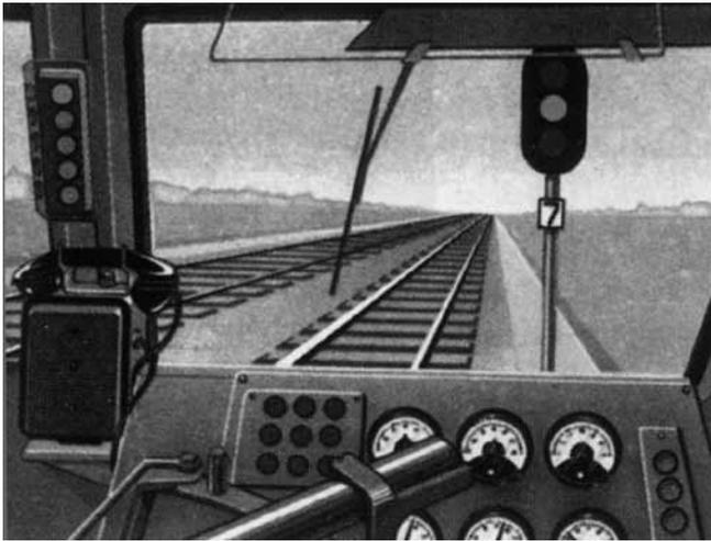
Рис. 4. Кабина машиниста с автоматической локомотивной сигнализацией
