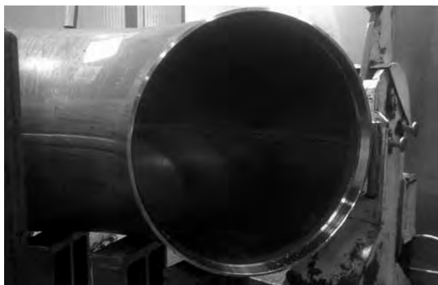
Рис. 1. Обработанная фаска на торце элемента трубопровода
