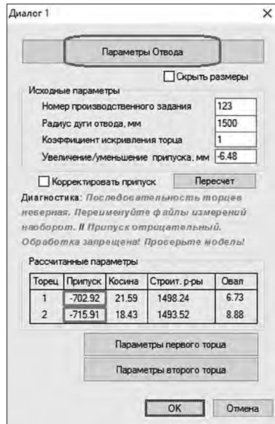
Рис. 5. Диагностика возможности обработки (либо брак заготовки, либо некорректно введенные данные)
