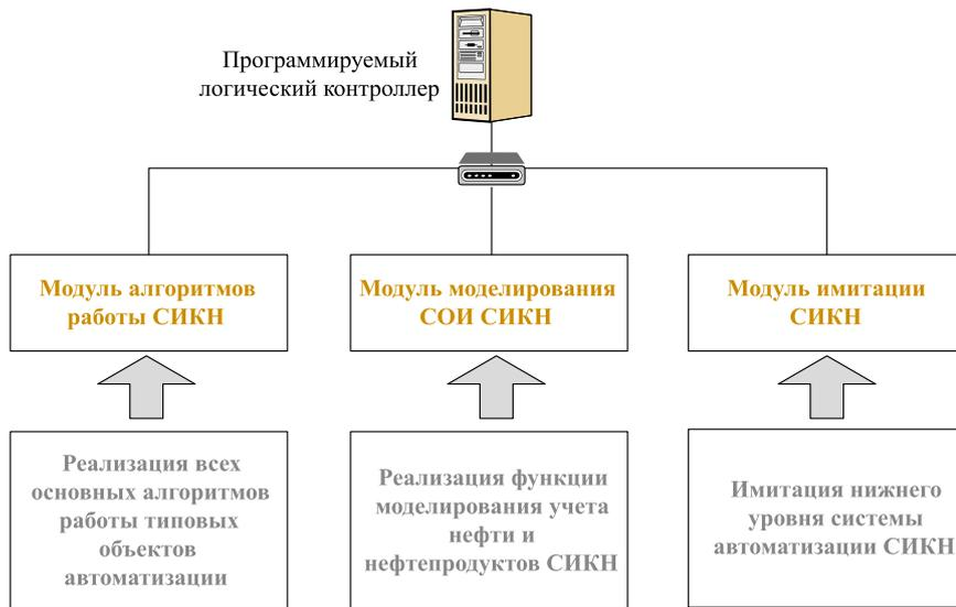
Рис. 2. Состав модулей ПЛК
