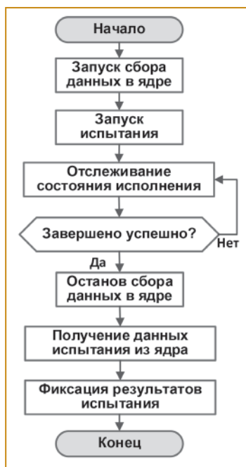
Рис. 4. Алгоритм испытания и получения данных от станка
