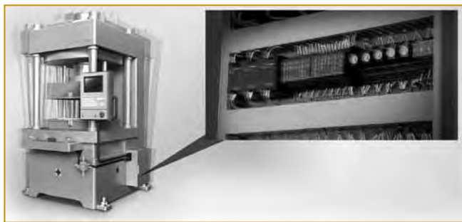
Рис. 6. Значительное сокращение размера шкафа автоматки
