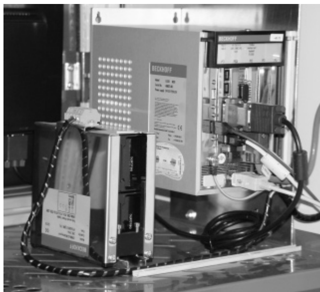
Рис. 2. Система управления на базе ПК для системы диагностики колес R2010
