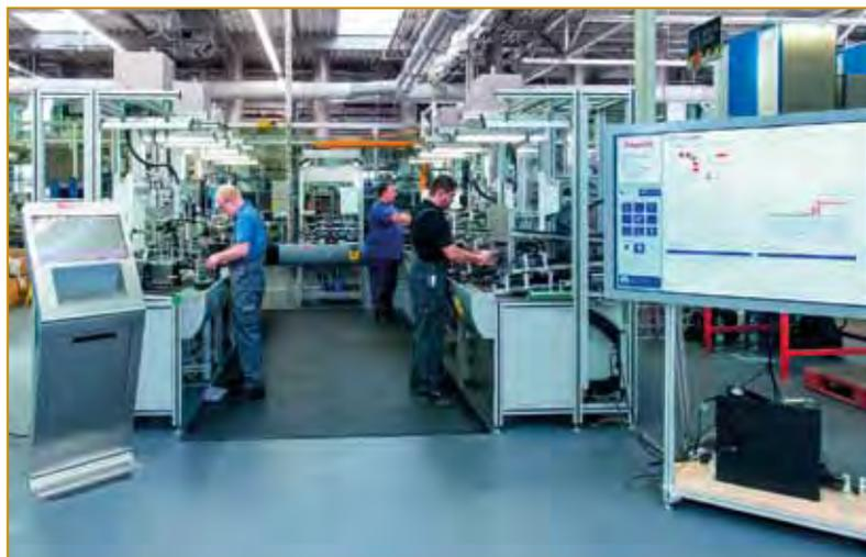
Рис. 4. На сборочной линии завода Bosch Rexroth в Хомбурге/Саар идет сборка более 200 типов различных гидравлических клапанов. Справа видна интерактивная платформа ActiveCockpit. ПО подготавливает ключевые показатели производительности в графическом виде и оперативно передает их на большой сенсорный экран
