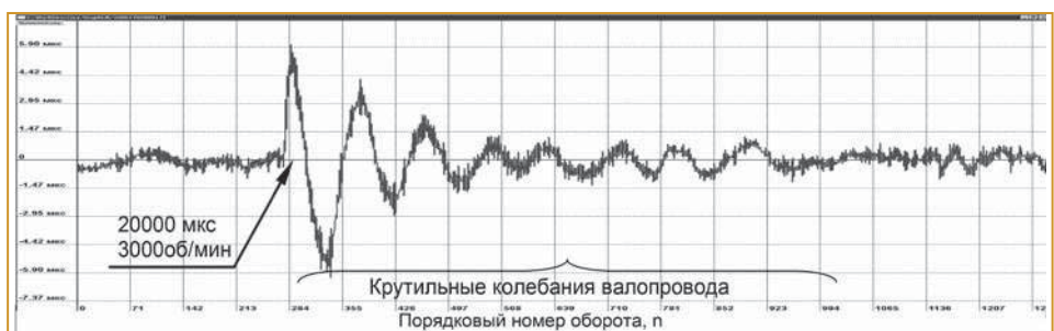
Рис. 2. Экспериментальная периодограмма крутильных колебаний валопровода ТА Т-250 с исключением тренда
