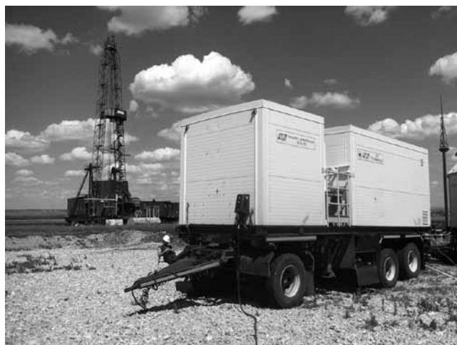
Рис. 3. Мобильная ИУ Мера-МР на промысле
