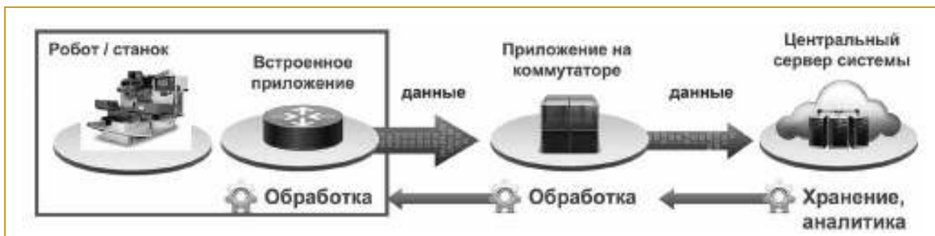
Рис. 2. Поток данных в системе мониторинга
