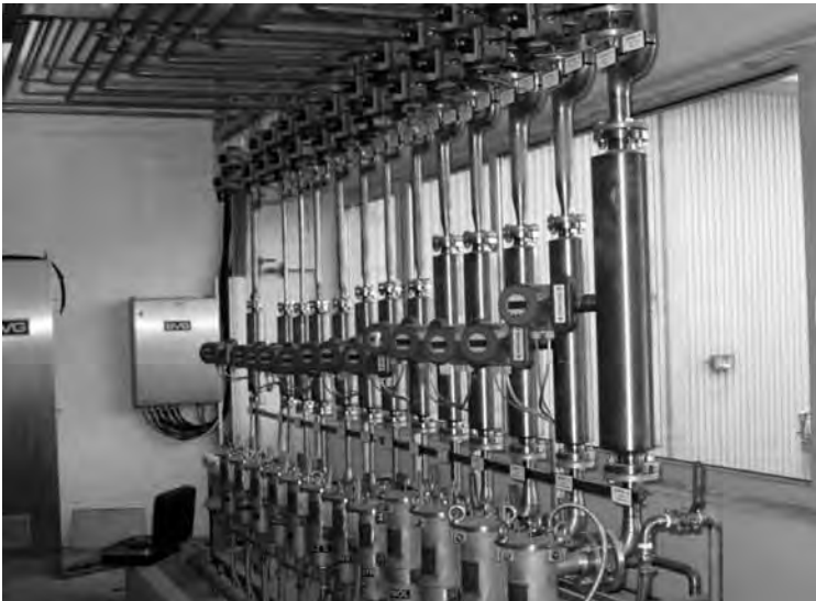
Рис. 1. Установка измерения объемного расхода и плотности в красильном цехе фирмы «Бауер Технологии» (г. Грайфенберг)
