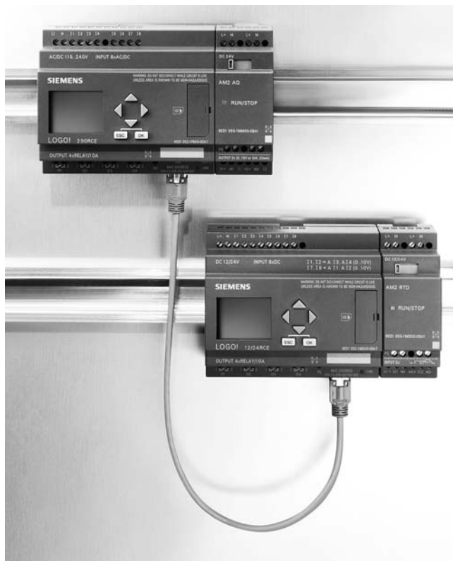
Рис. 2. Объединение модулей LOGO! в сеть Ethernet
