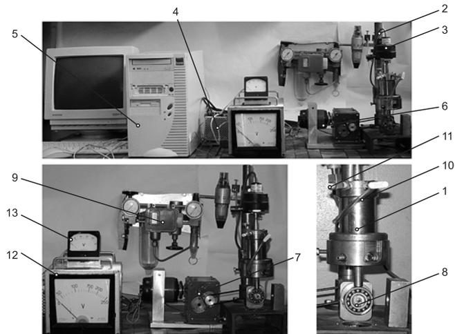
Рис. 7. Экспериментальная установка, где 1 – широкопредельный струйный датчик; 2 – стойка; 3 – бесконтактный датчик положения ДПА-М30-76У-1110-Н с аналоговым выходом (индуктивный); 4 – модуль аналогового ввода/вывода ADB13x140; 5 – ПК; 6 – двигатель постоянного тока СЛ-267; 7 – редуктор; 8 – эксцентрик; 9 – блок подготовки воздуха; 10 – трубопроводы; 11 – дроссель; 12 – латер; 13 – вольтметр
