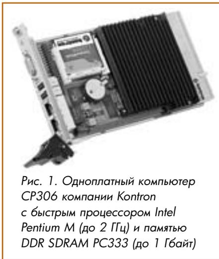
Рис. 1. Одноплатный компьютер SR306 компании Kontron с быстрым процессором Intel Pentium M (до 2 ГГц) и памятью DDR SDRAM PC333 (до 1 Гбайт)
