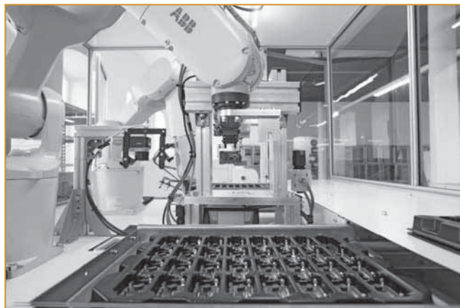
Роботизированный комплекс для автоматизации участка сборки и пайки гибких шлейфов экранов к печатным платам
