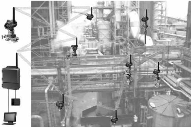
Рис. 2. Схема функционирования самоорганизующихся ячеистых сетей
