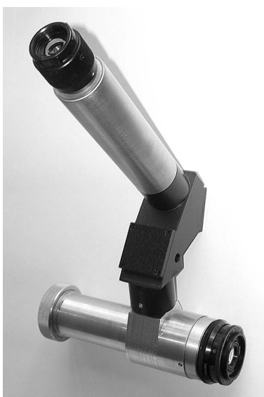
Рис. 1. Фотодиодный пирометрический преобразователь с визирным окуляром
