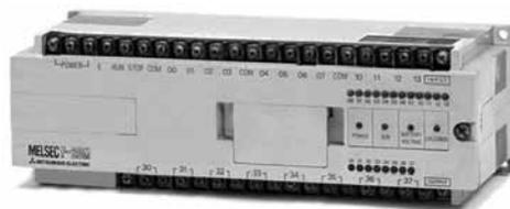
Рис. 2. Компактный ПЛК MELSEC-F 1981 г.
