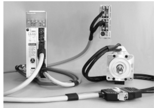
Рис. 2. Серводрайвер, сервомотор и кабели сер. MINAS A, подключенные к ПЛК сер. FP-Sigma
