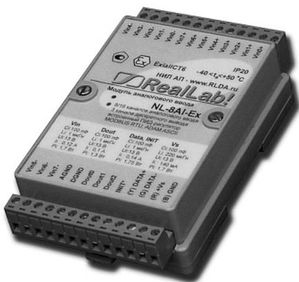
Рис. 2. Внешний вид модуля аналогового ввода NL-8AI-Ex
